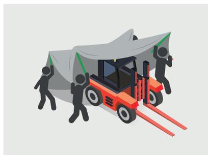
Nadzvedni deku pomocí teleskopických tyčí a táhni ji centrálně přes dopravní prostředek.
