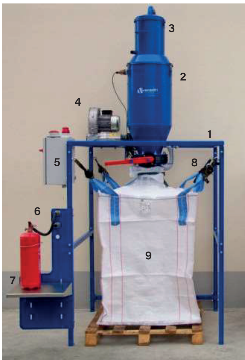
Odběr suchého prášku z hasicích přístrojů pod stálým tlakem
